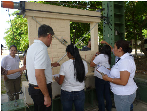
(枠組組積造壁の水平載荷実験)
